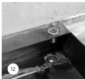
12-15: Monteer de 4 meegeleverde schroeven met de sleutel in de schroefgaten waarin eerst de stelschroeven waren gemonteerd.
