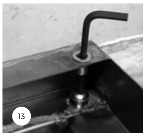
12-15: Monteer de 4 meegeleverde schroeven met de sleutel in de schroefgaten waarin eerst de stelschroeven waren gemonteerd.
